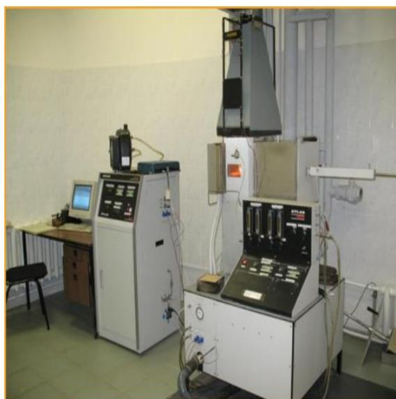
Рис. 1 – Проточный калориметр OSU марки HRR – 3
