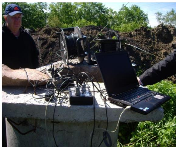
Рис. 3. Пункт сбора данных динамико-геофизических испытаний воздействия динамических и фоновых нагрузок на грунтовый массив в районе строительной площадки, строящегося жилого комплекса и автомобильной дороги в месте схода оползня.
