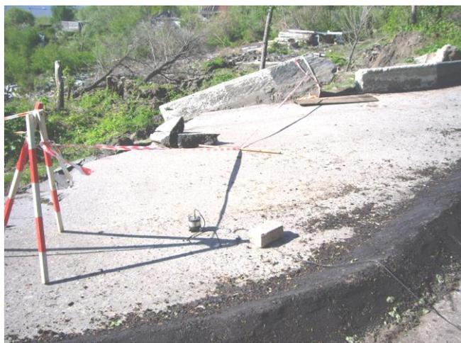
Рис.2. Установка мобильной системы динамико-геофизического мониторинга оползнеопасного участка дороги в г. Ульяновск
